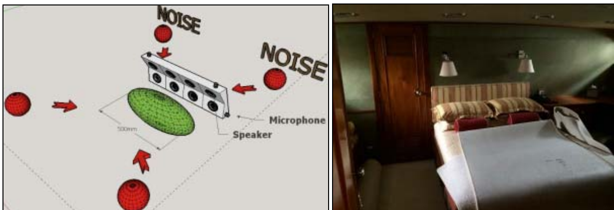
Figuur 4.4.3: voorbeeld antigeluid systeem
