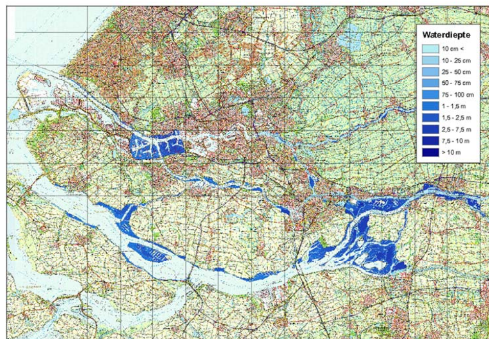
Figuur B5.2 Inundatiediepte van buitendijkse gebieden in Plan Sluizen bij een frequentie van 1/1000 per jaar (Defacto, 2015, HKV, 2015c)
