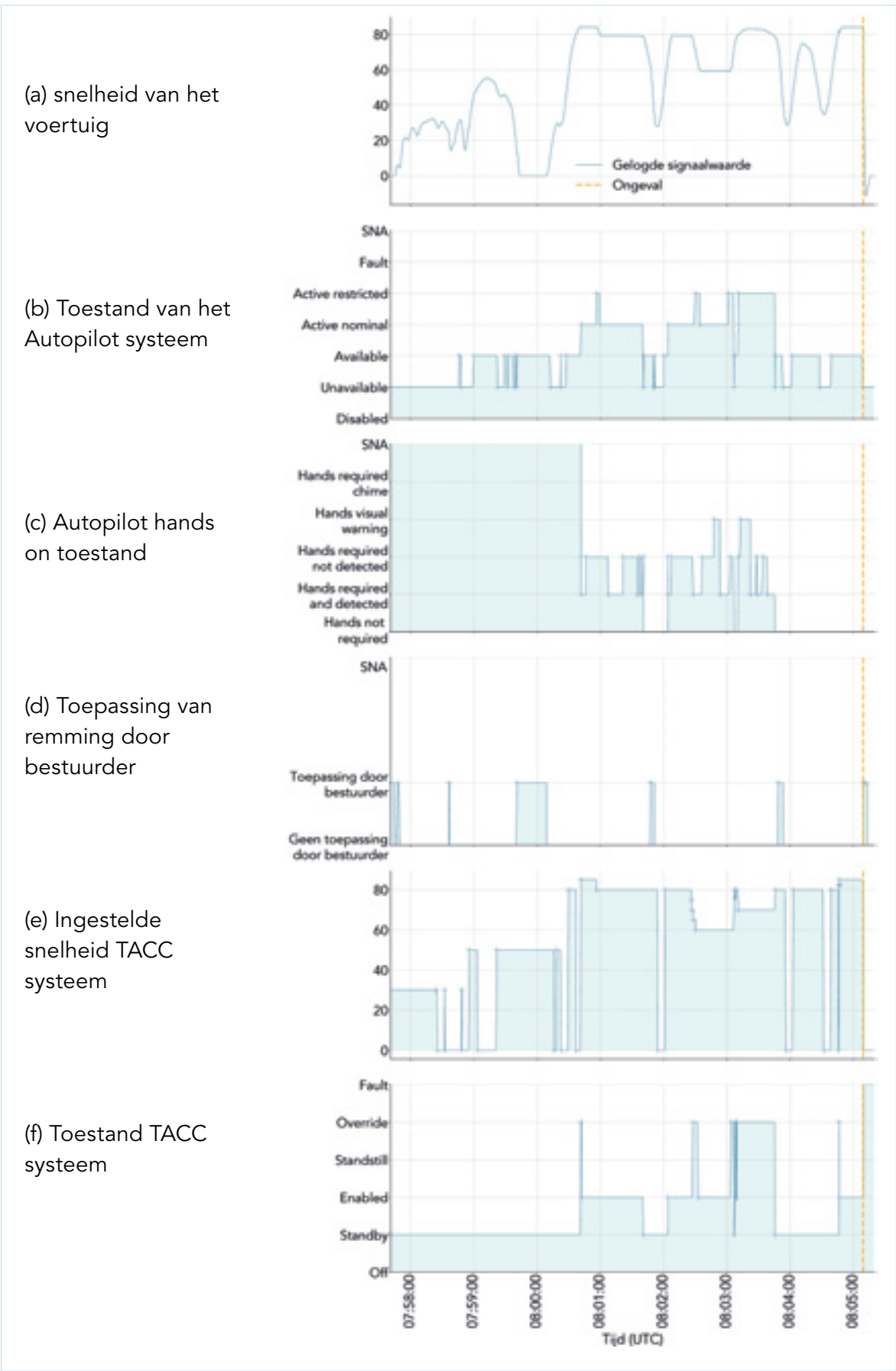
Figuur 29: Tijdreeksregistratie van een aantal parameters afkomstig van de logbestanden uit het voertuig (Tesla Model S, Zeeland).
