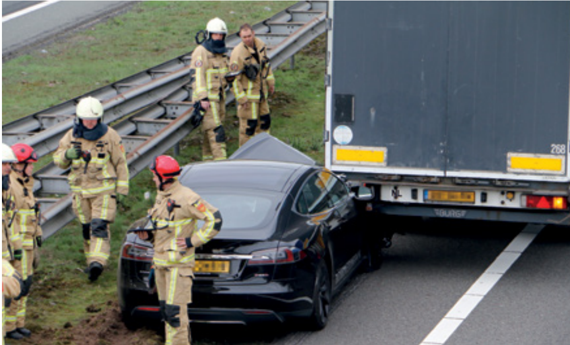
Figuur 21: Tesla Model S ongeremd achterop van baan wisselende vrachtwagen gereden met een snelheid van ongeveer 127 km/uur.
