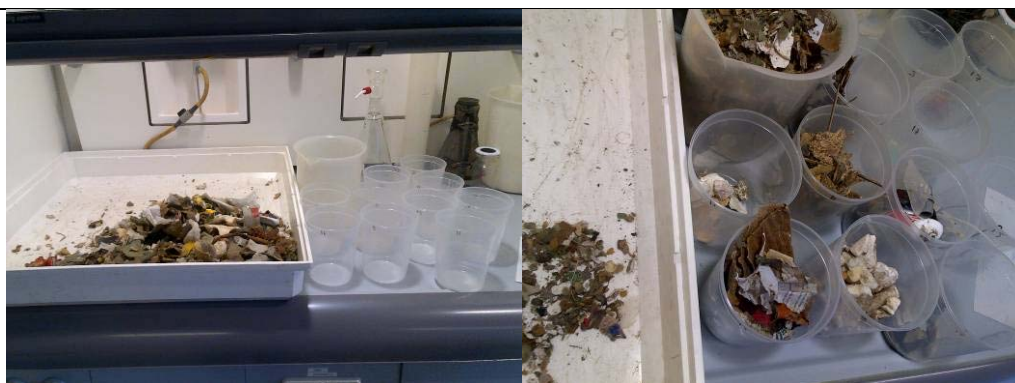
Figuur 3.5 Analyse residu kleiner dan 80 mm in Tauw laboratorium. Links het monster, rechts de verschillende fracties
