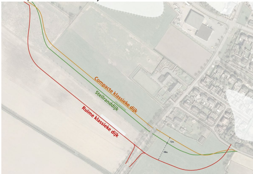
Figuur 3-22: Ruimtebeslag van de drie alternatieven bij De Paad west
