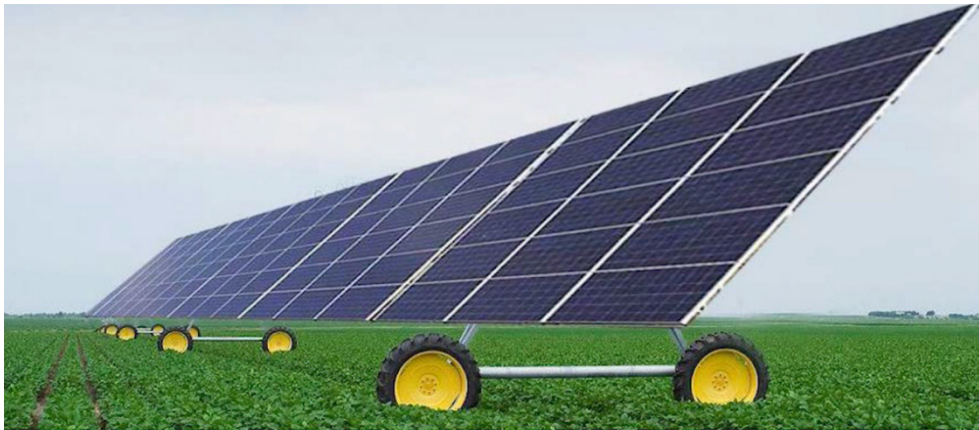
Figuur 18 Zonnepanelen op rijdende constructie. Bron: RVO-prijsvraag zonnestroom, https://www.youtube.com/watch?v=DQdzRsC3qTU .
