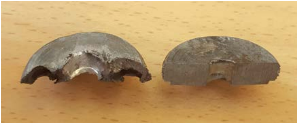
Figuur 15: Links de bovenzijde van de afsluitplaat uit de test in gewapende stand. Rechts de afsluitplaat van het ongeval. De afsluitplaat in gewapende stand is gebroken als gevolg van de detonatie, de afsluitplaat uit het ongeval is intact teruggevonden, maar is doorgezaagd voor nader onderzoek. (Foto: TNO)
