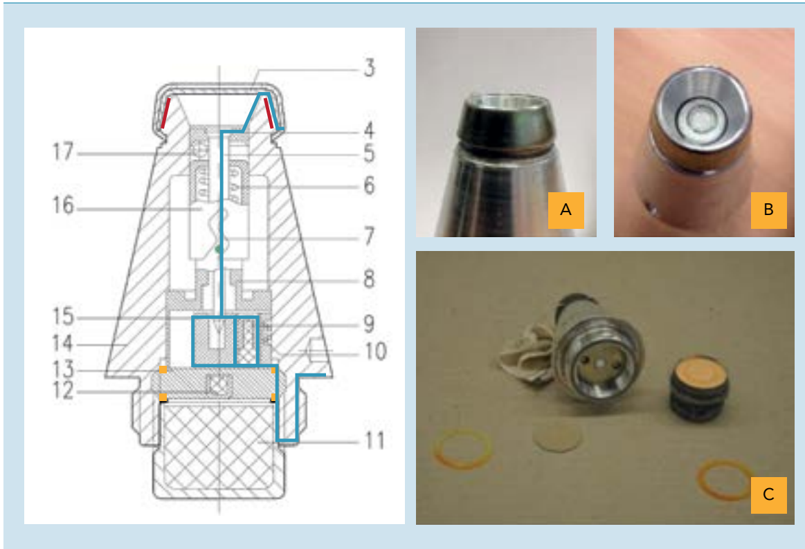
Figuur 22: Doorsnede schokbuis met potentiële routes (blauw) voor indringing van vocht via lijmlaag (rood) en afdichtringen (geel). Foto A: Lijmlaag voor het membraan, foto B: opening tussen slagpin en huis en foto C: onderzijde huis met afsluitplaat, booster met kartonnen afdekplaatje en twee rubberen ringen. (Bron: TNO)
