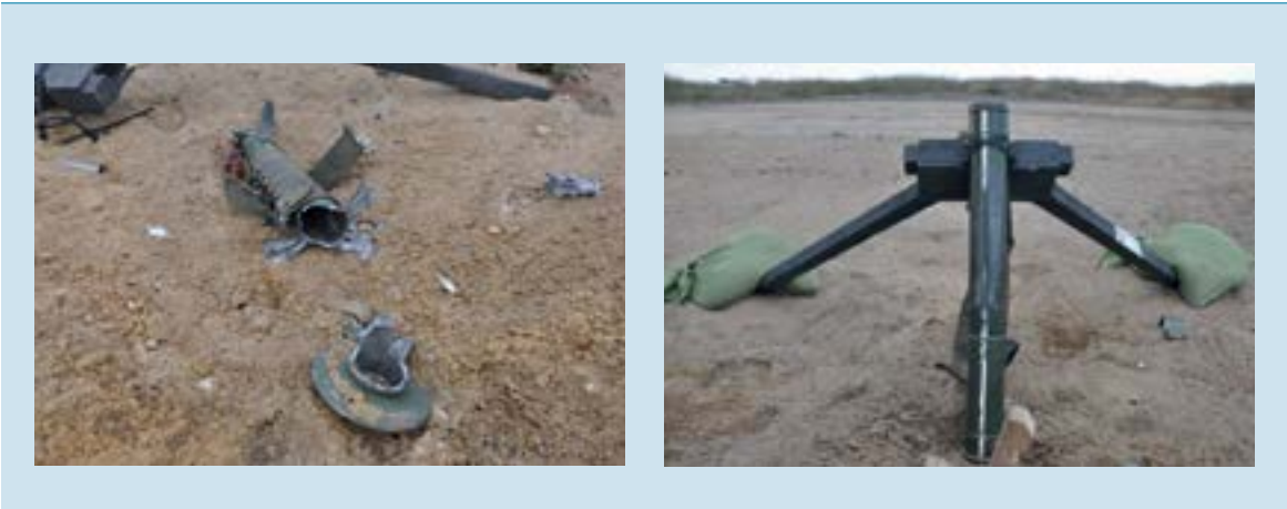
Figuur 8: Schietbuis na een inwendige detonatie (links) en deflagratie (rechts) van een 60 mm mortiergranaat op basis van referentieproeven KCW&M. (Foto's: KCW&M)
