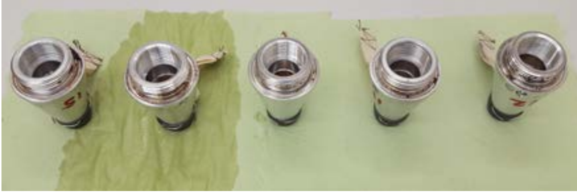
Figuur 23: De lijmlaag van één van de vijf M6-N schokbuis behuizingen is lek na een valtest vanaf ongeveer 1 meter hoogte met willekeurige oriëntatie. (Foto: TNO)
