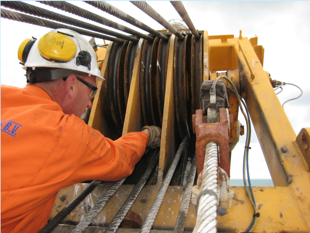
Foto: Controle van de groefslijtage in de schijven door een inspecteur van een CI; bron SodM
