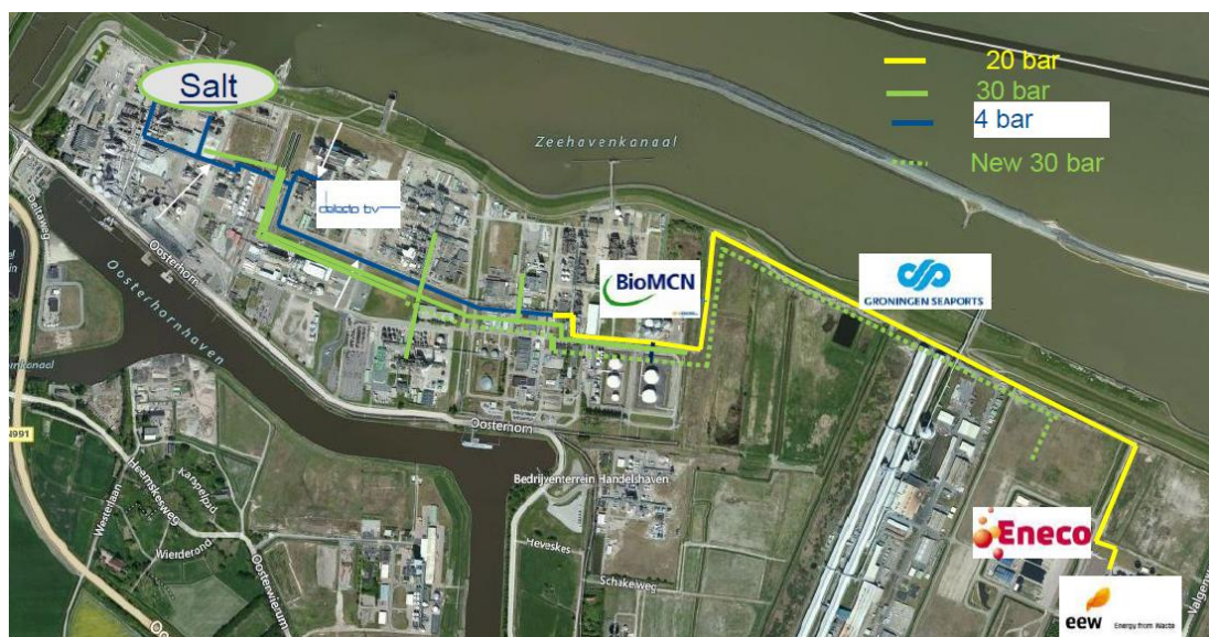
Figuur 6. Stoomnet op het Chemiepark.
