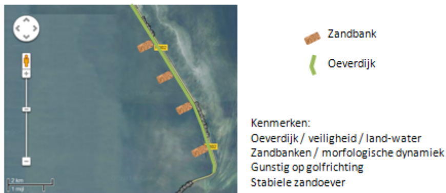
Figuur 3.9 Oeverdijk langs Houtribdijk met extra zandbanken
