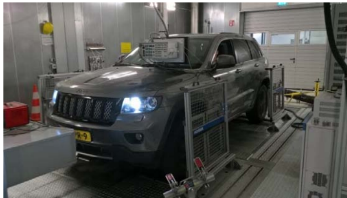
Figuur 2-1: Een Jeep Grand Cherokee op de rollenbank.
