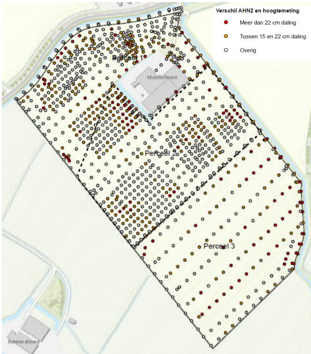
Fig. 5.12 Kaart met berekend hoogteverschil hoogtemeting 2020 en AHN-2 (2009) op meetpuntniveau
