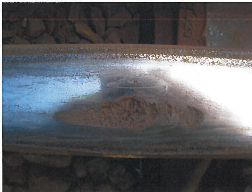
Figuur 9. Squat, type C, te Zeeuws Vlaanderen
