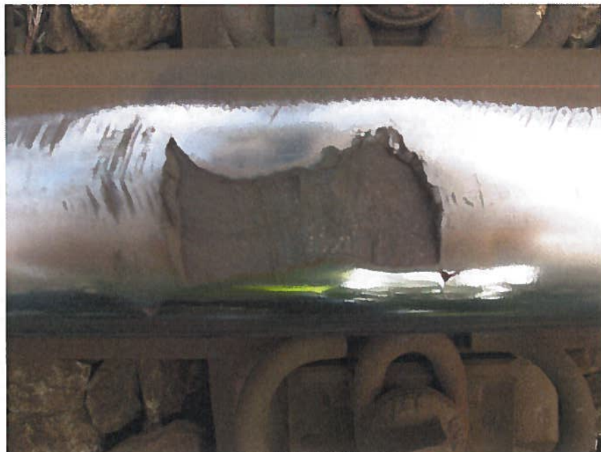
Figuur 15. Squat, type C, met materiaaluitbrokkeling
