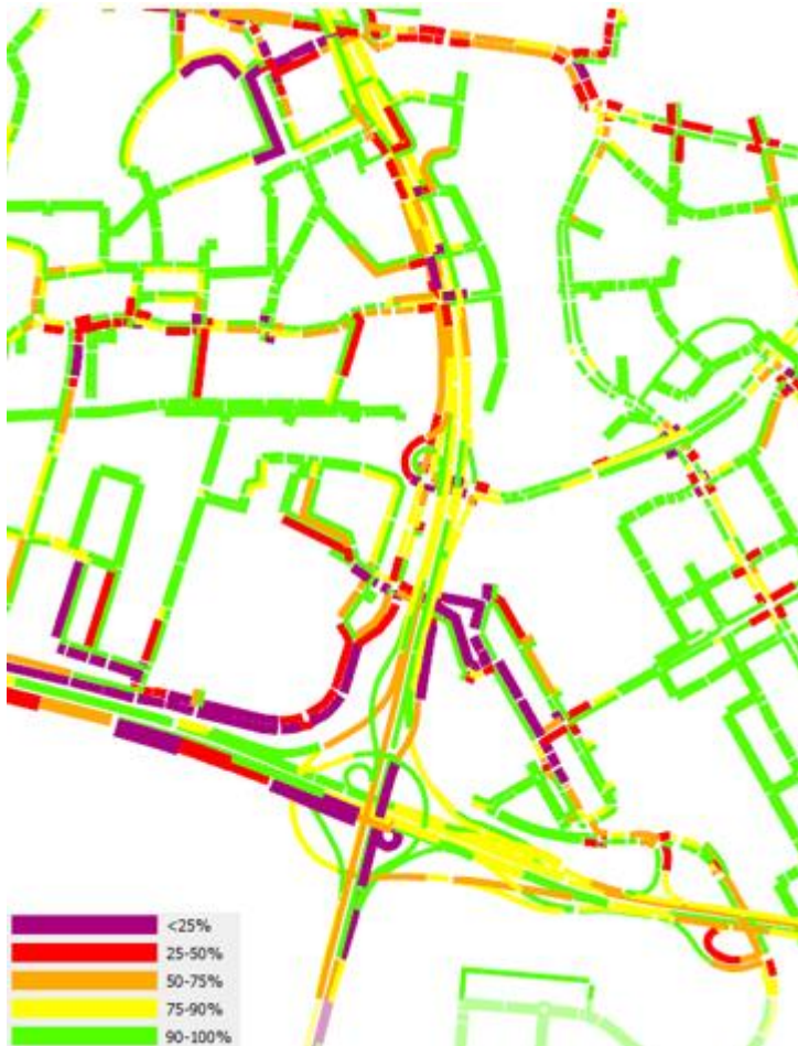
Figuur 41: Snelheidsreductieplot druk moment avondspits (paars is stilstaand verkeer).
