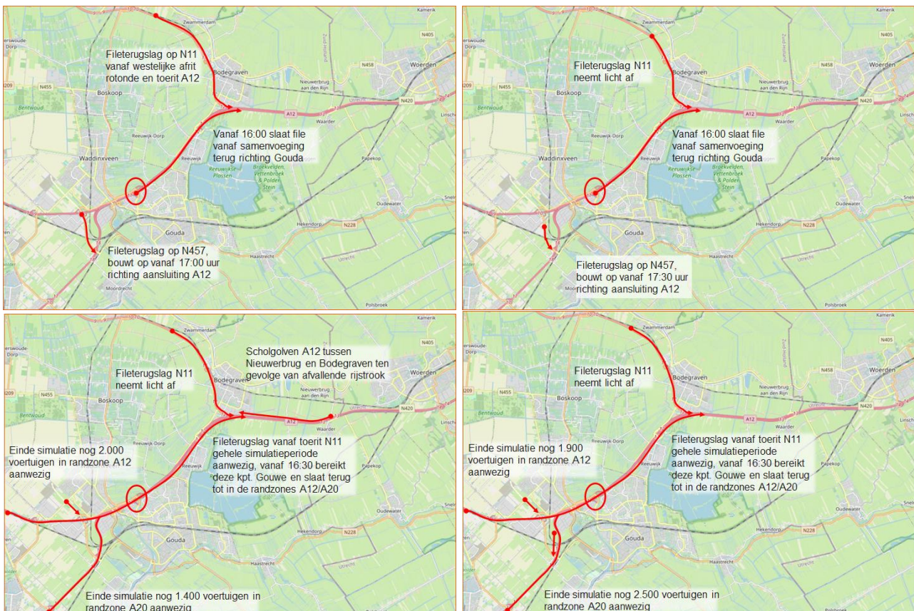
Figuur 46: Filebeelden avondspits voor de autonome situatie (linksboven) en de maatregelpakketten Nulplus (rechtsboven), Partieel (linksonder) en Asymmetrisch (rechtsonder)
