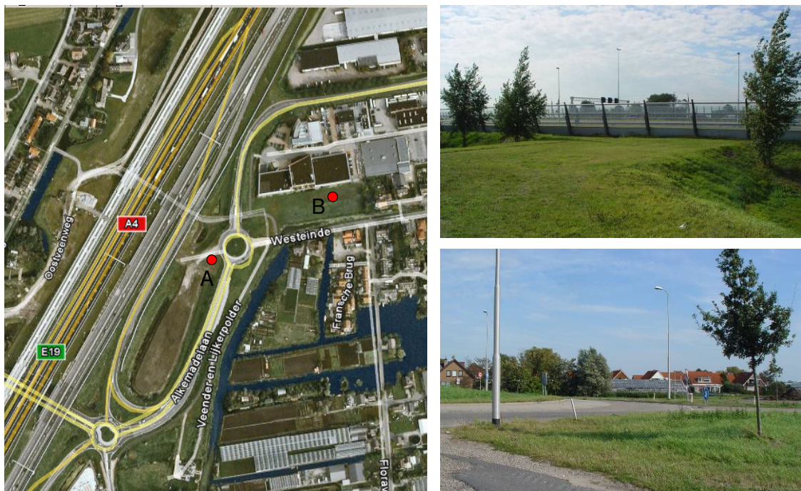
Figuur 2.4: Foto's van de locatie in Roelofarendsveen. Op de luchtfoto links ligt het spoor van de HSL (hier nog in aanbouw) links van rijksweg A4. De rode punten in deze foto zijn de posities van de microfoons (A en B, meethoogte 3,5 meter ten opzichte van het maaiveld).
