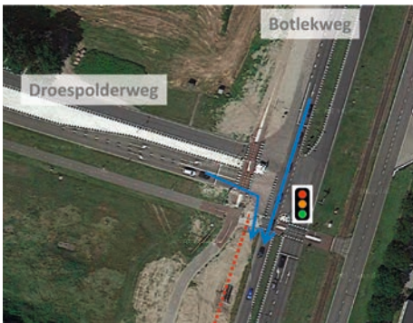
3 Verdubbelen Botlekweg, rechtsaf vanaf Droespolderweg en doorgaand op Botlekweg gelijktijdig groen licht geven
