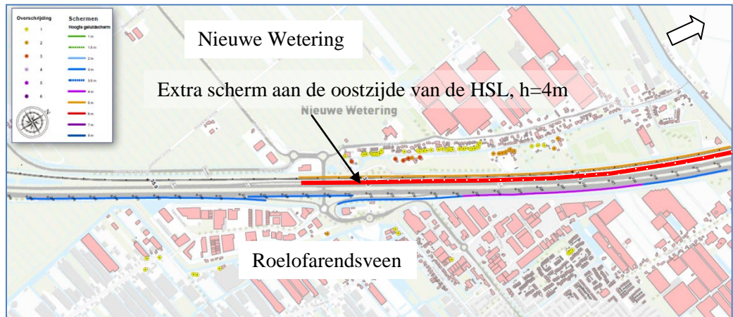
Figuur 11-4 NW/RV1 Scherm aan de oostzijde van de HSL (Nieuwe Wetering en Roelofarendsveen)
