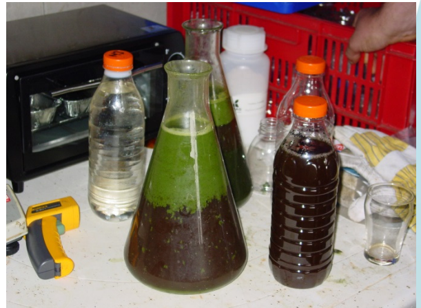
Figuur 12: Uitvlokken persfractie experiment bioraffinage plantenresten (bron: Royal HaskoningDHV)
