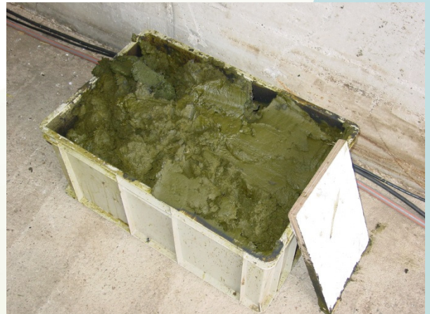
Figuur 13: Gewonnen eiwitfractie experimenten bioraffinage plantenresten (bron: Royal HaskoningDHV)
