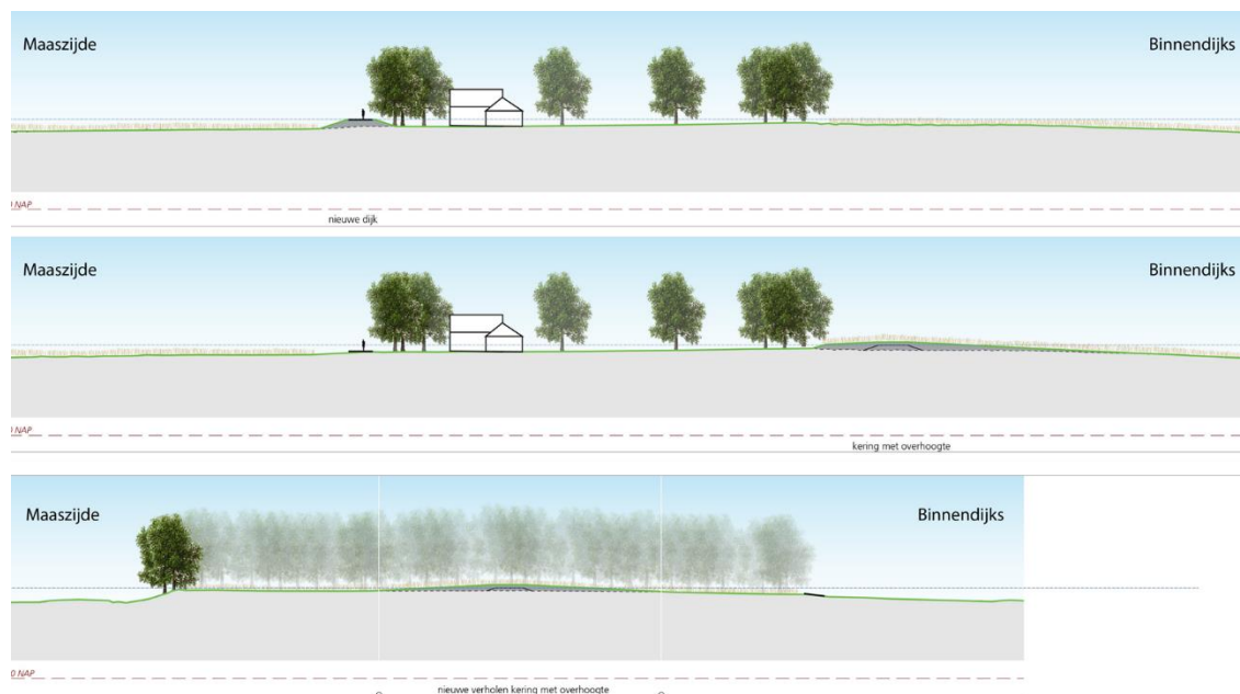
Figuur 11 Dwarsprofielen varianten locatie Bossebrugweg (DP1: boven Variant A, midden Variant B) en Bloemenstraat (DP2: onder Variant A)
