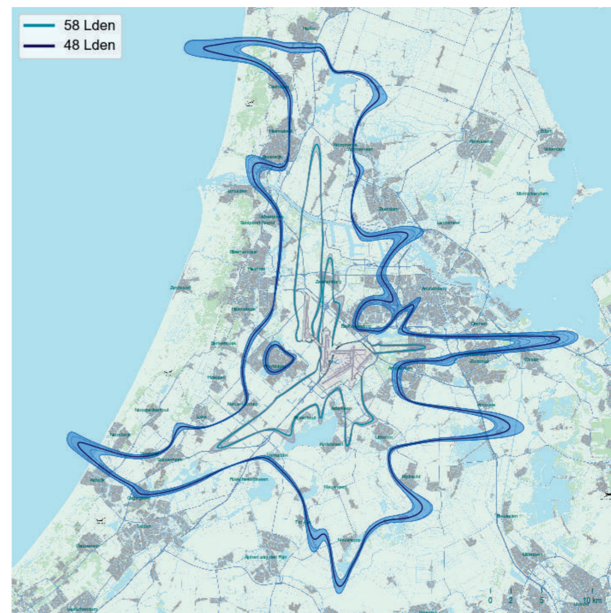
Figuur 5.1: Verwachte jaargemiddelde geluidbelasting over het etmaal L den voor gebruiksjaar 2019, met spreiding als gevolg van weersvariaties
