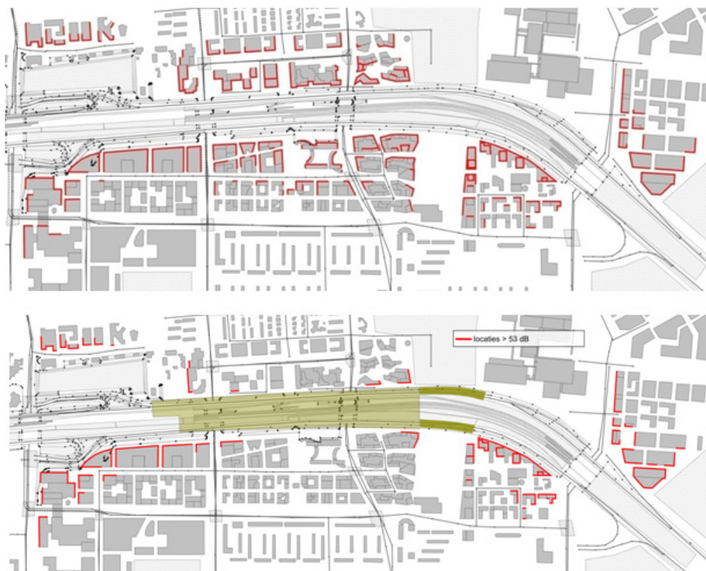
figuur 5.4 Gevels met een geluidbelasting boven de maximale ontheffingswaarde A10 zonder (boven) en met de realisatie van de beleidskeuzes (onder)
