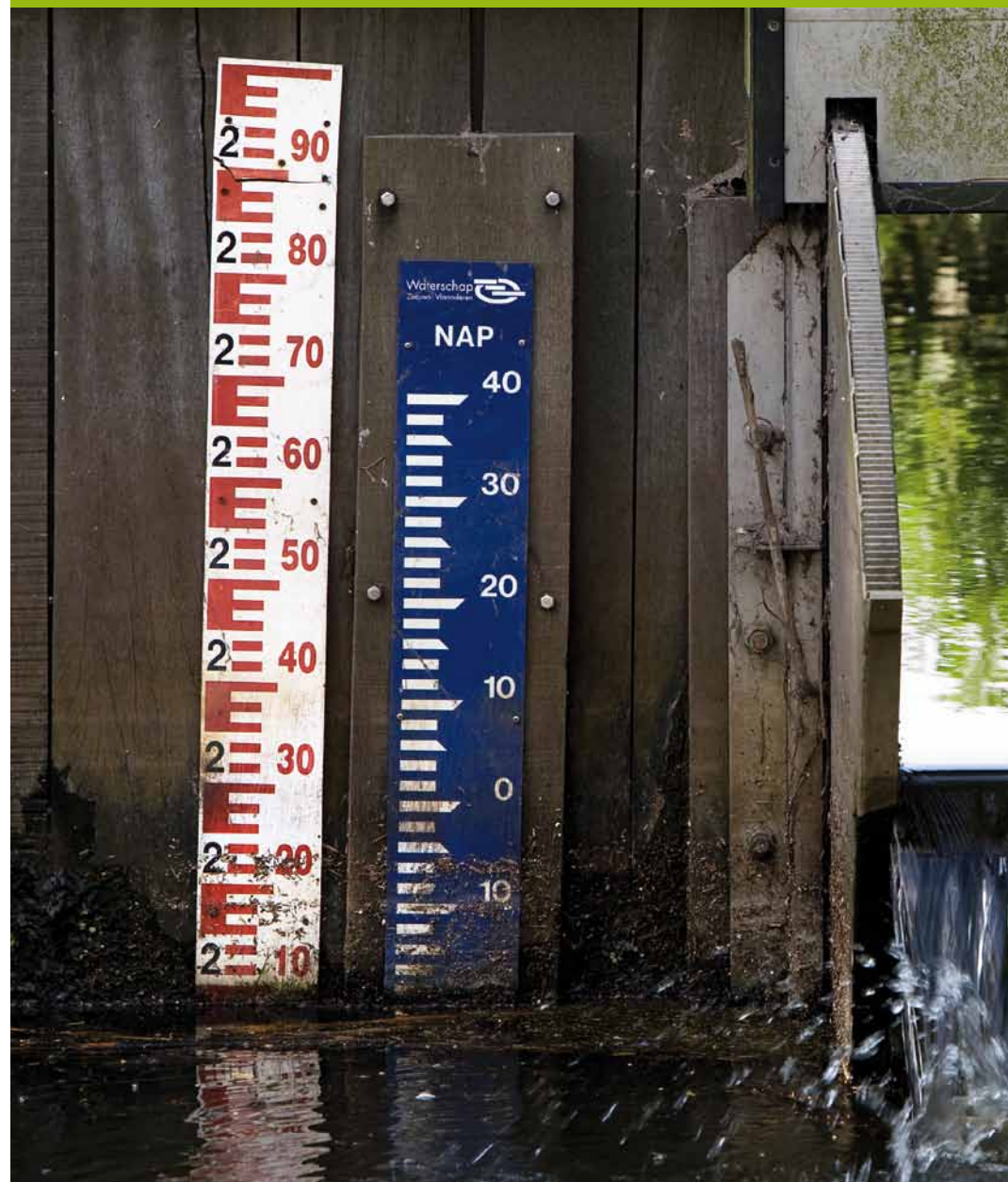
Belgische peilschaal naast een Nederlandse NAP-schaal
