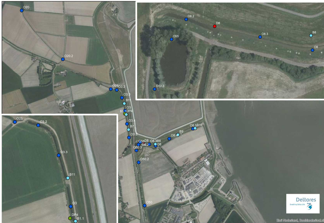
Figuur 15. Meetlocaties voor oppervlaktewater en peilfilters direct naast de kwelsloot: met uitvergrotingen van de westelijke (linksonder) en zuidelijke kwelsloot (rechtsboven).
