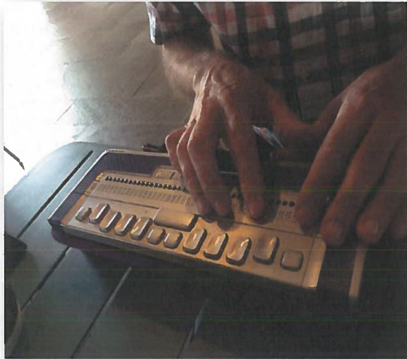
Leesregel: apparaat dat digitale tekst in braille omzet
