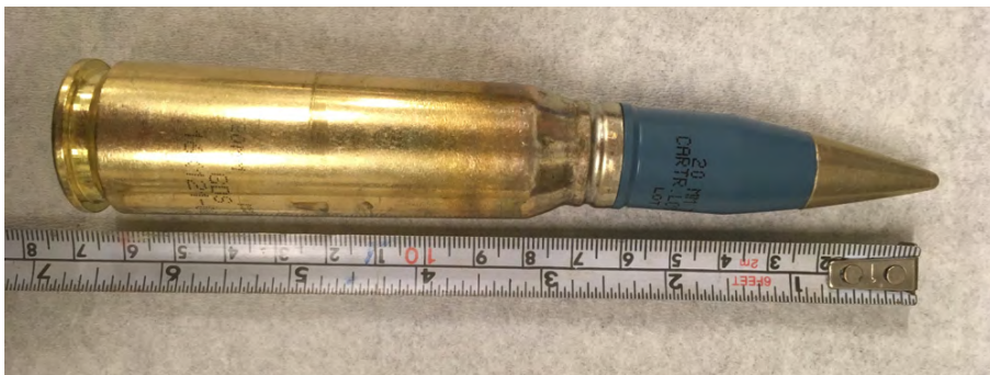
Figuur 15 Voorbeeld van beschadigde munitie. De patroon is verbogen en de huls van de patroon heeft diverse beschadigingen bij de flensrand (bron: IVD).
