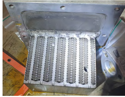
Figuur 10 Schade aan een van de oliekoelers (bron: NLR).
