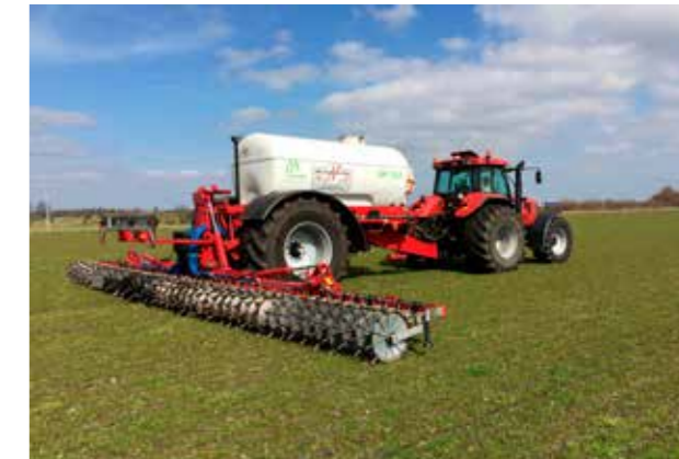
Toediening van spuiwater met een spaakwielbemester voorkomt dat ammoniak alsnog verloren gaat bij de toediening.
