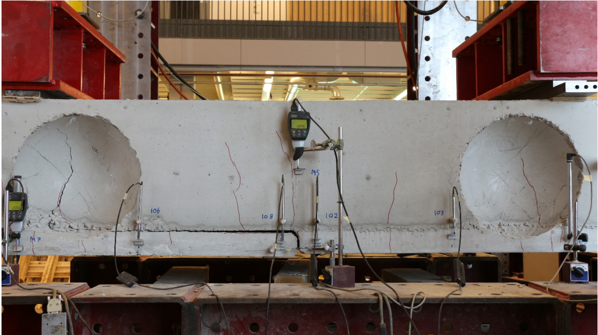
foto 14 Proefstuk TF450BR na het bereiken van de maximale weerstand bij een belasting van 118 kN en een scheurwijdte rechts 1 (op de foto links) gelijk aan 7,7 mm.
