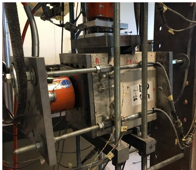
foto 15 Opstelling na bezwijken proefstuk
